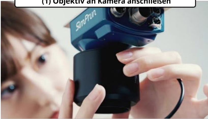
(1) Objektiv an Kamera anschließen
